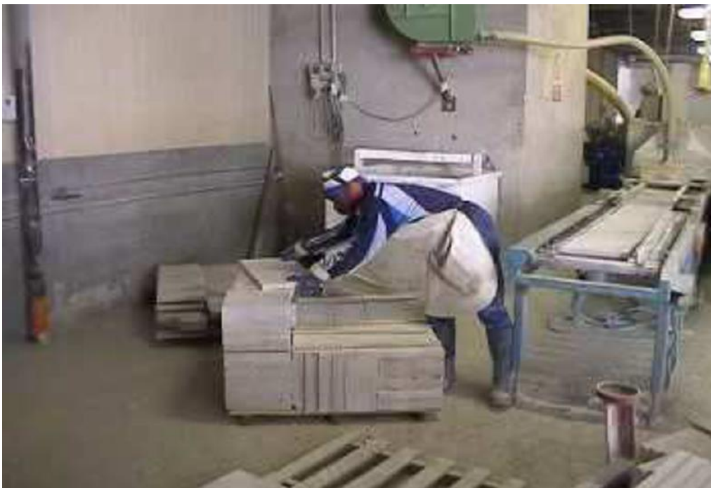
Figura 1 - Operaio marmista impegnato nel caricamento di una linea di lucidatura
